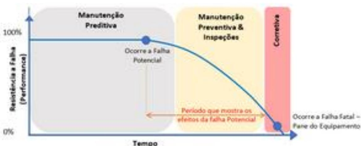
Figura 2 – Curva de falhas PF. Fonte: Modular Cursos
